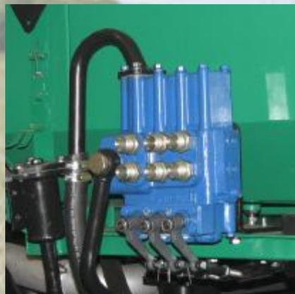
Гидрораспределитель трехсекционный Р80-З/1-222Г
