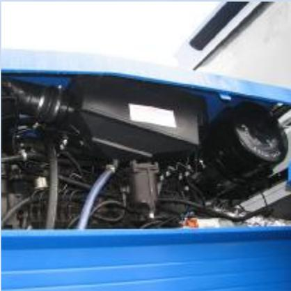
Двух ступенчатая система очистки воздуха
