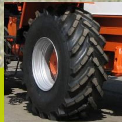
Колеса с шинами размера 23,1R26 мод. Ф37
