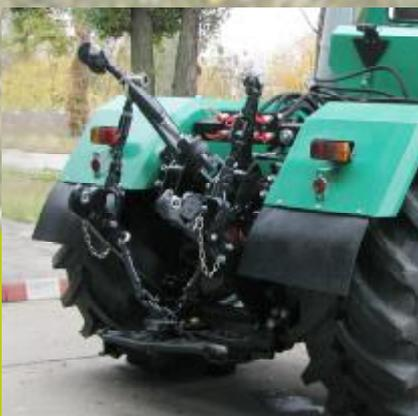
Двухцилиндровое навесное устройство грузоподъемностью до 6т
