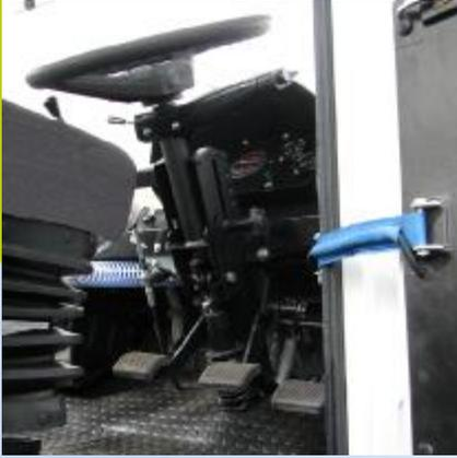
Рулевая колонка, регулируемая по углу наклона и высоте
