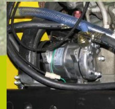
Компрессор автомобильного кондиционера (в комплекте)
